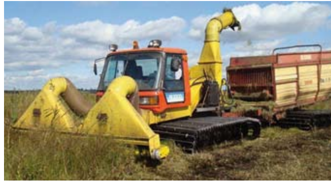
Abb. 14: Geeignete Maschinenteknik für Paludikulturen auf wiedervernässten Mooren (links: Meyer-Luhdorf PB 240, Foto: Kees Vegelin 2011; rechts: modifizierte Pistenraupe, Ratrak, Foto: Lars Lachmann 2011)
