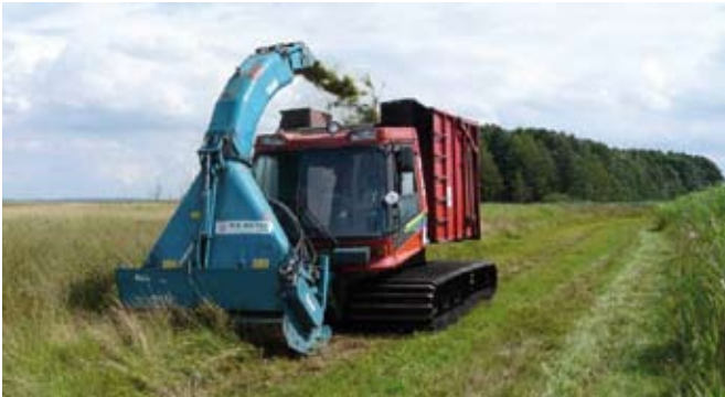
Abb. 14: Geeignete Maschinenteknik für Paludikulturen auf wiedervernässten Mooren (links: Meyer-Luhdorf PB 240, Foto: Kees Vegelin 2011; rechts: modifizierte Pistenraupe, Ratrak, Foto: Lars Lachmann 2011)
