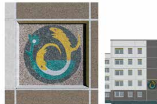
Vorschlag zur Sanierung der Plattenbauten unter Beibehaltung der originalen Giebelbroschen (Grafik Carl Emil Walther)
