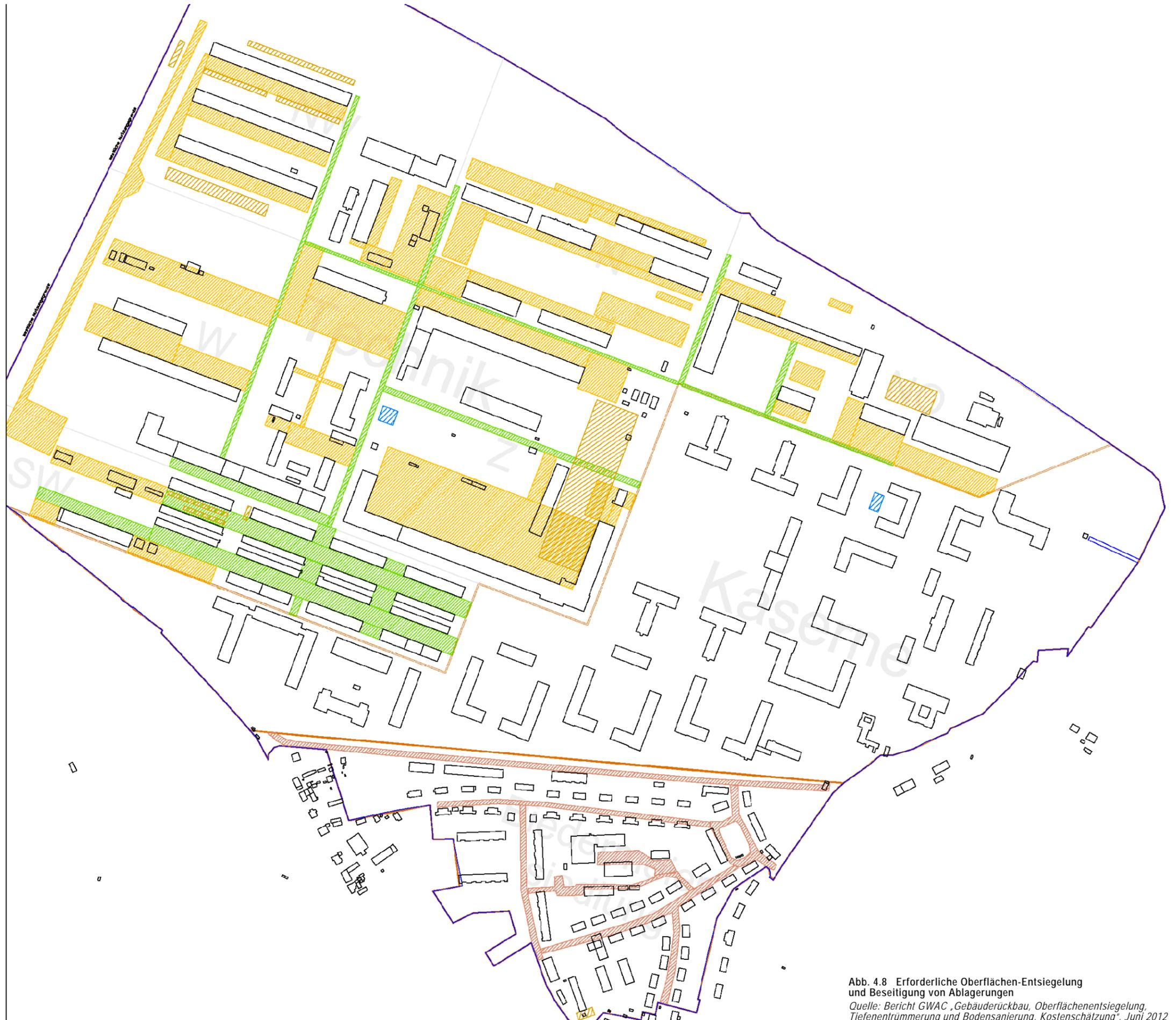
Abb. 4.8 Erforderliche Oberflächen-Entsiegelung und Beseitigung von Ablagerungen
