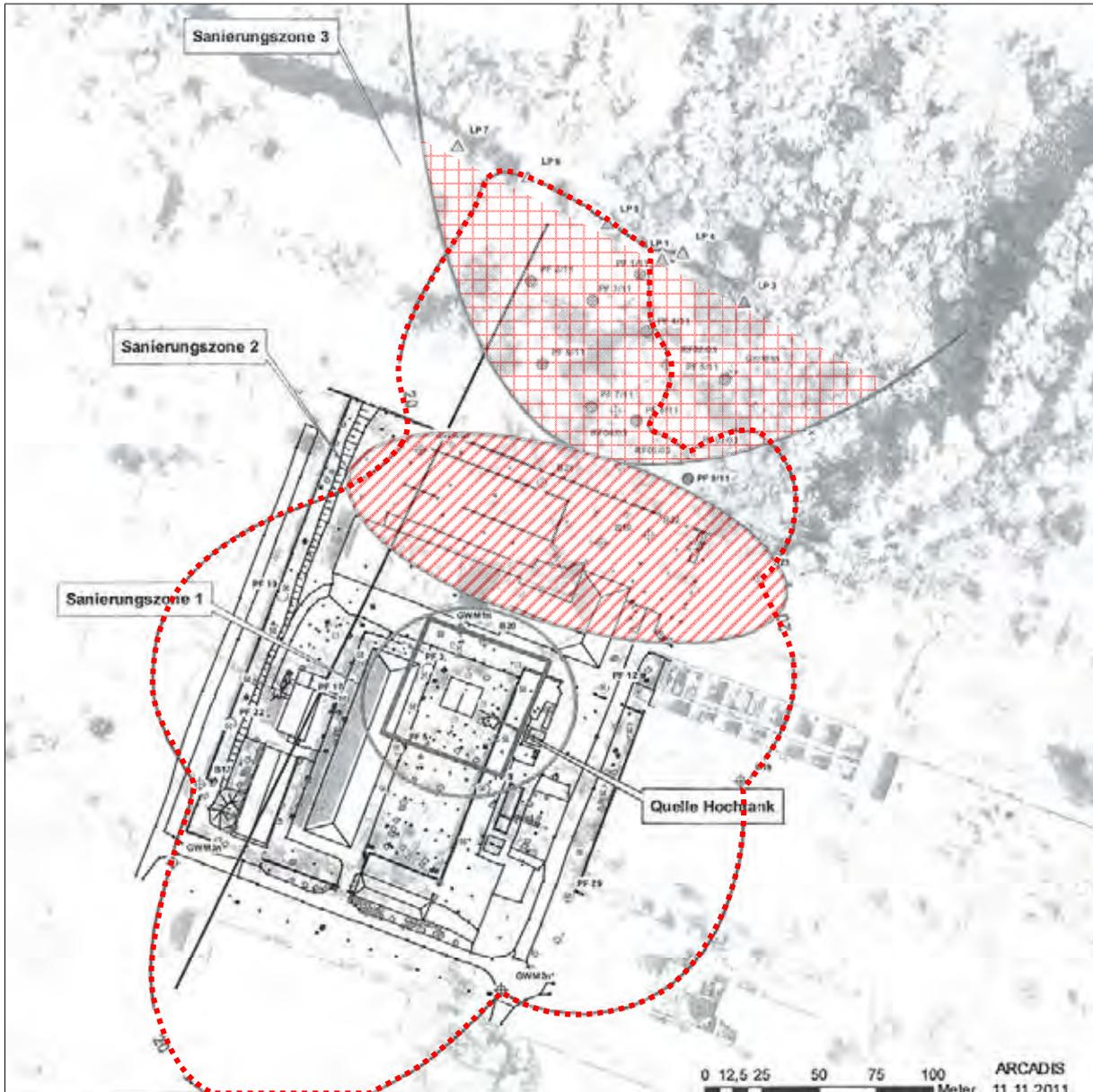
Abb. 4.11 Die 3 Sanierungszonen des Trichlorethen-Schadens im Bereich Wäscherei sowie der Bereich einer erhöhten Grundwasserbelastung (gestrichelte Linie).
