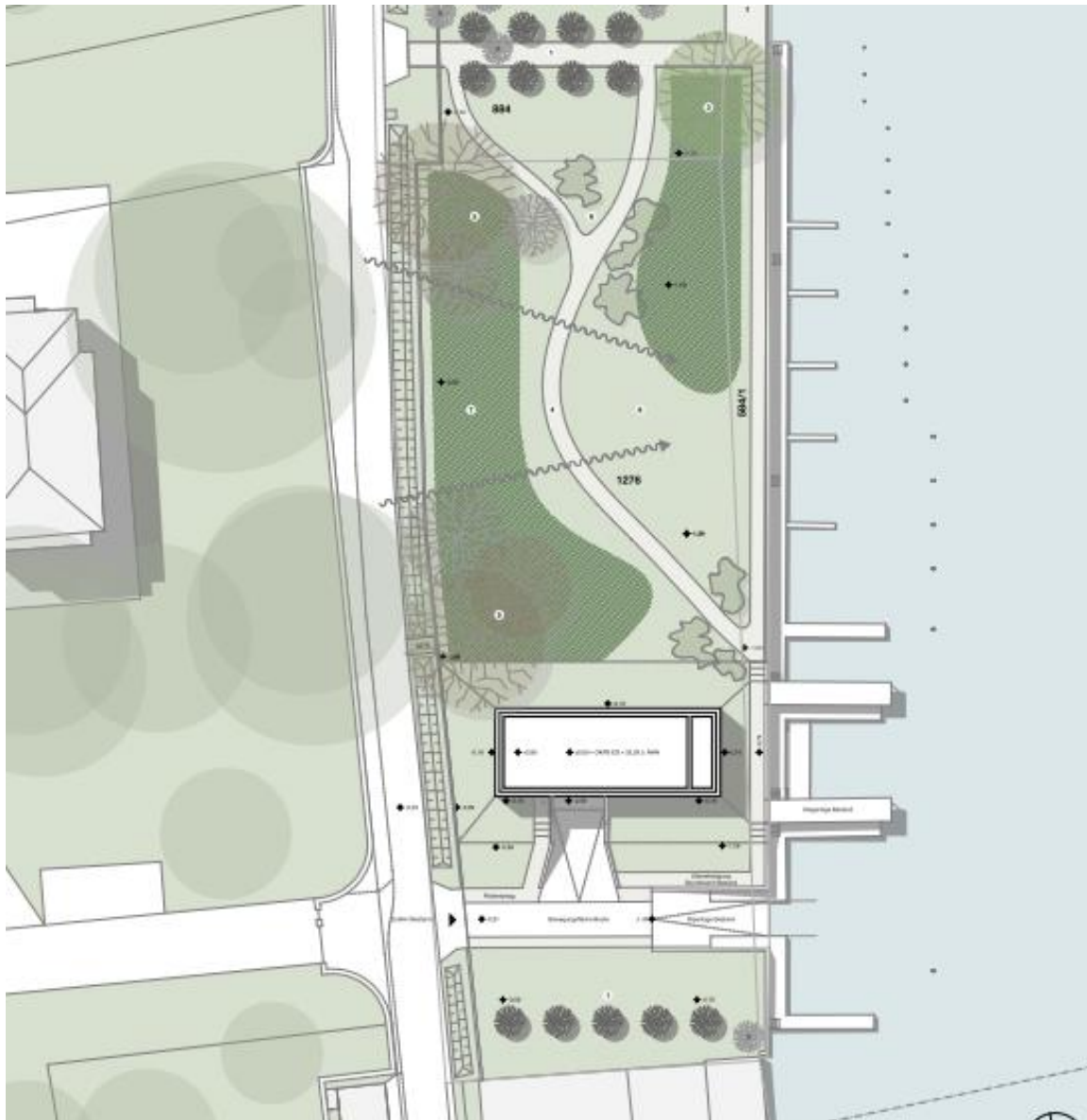
Abbildung 47: Außenanlagenplan. Gut zu erkennen ist die Lage der Zufahrt gegenüber der Zufahrt zum Grundstück der Villa Starck sowie die Lage des Gebäudes zwischen den beiden Spundwandvorstreckungen. 21
