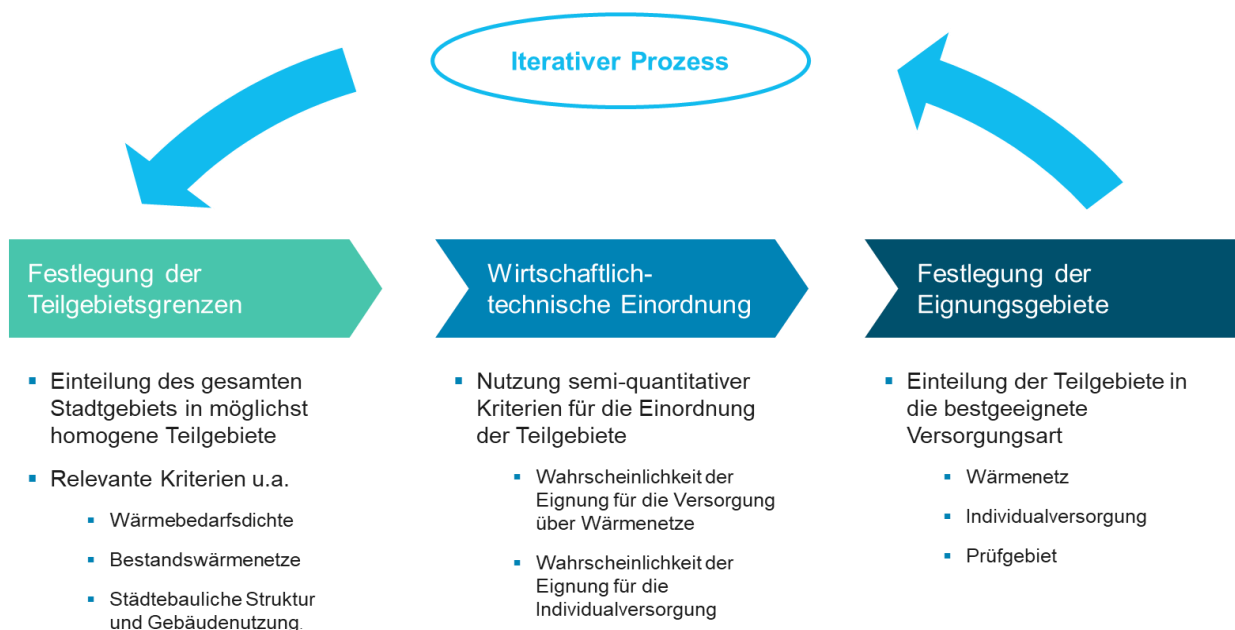
Abbildung 32: Vorgehensweise zur Gebietseinteilung angelehnt an den Leitfaden Wärmeplanung (Ortner, et al., 2024) (Eigene Darstellung)
