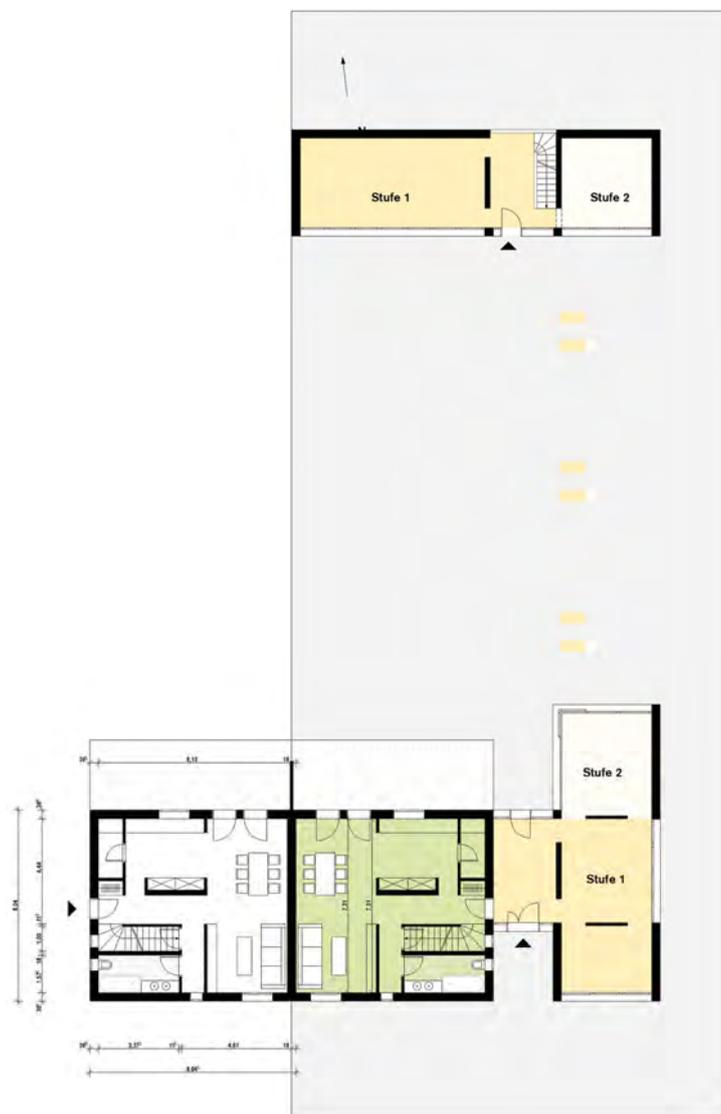
Abb. 5.8 Umplanung des Haustyps II im Berg-Viertel mit Erweiterungs-Möglichkeiten
